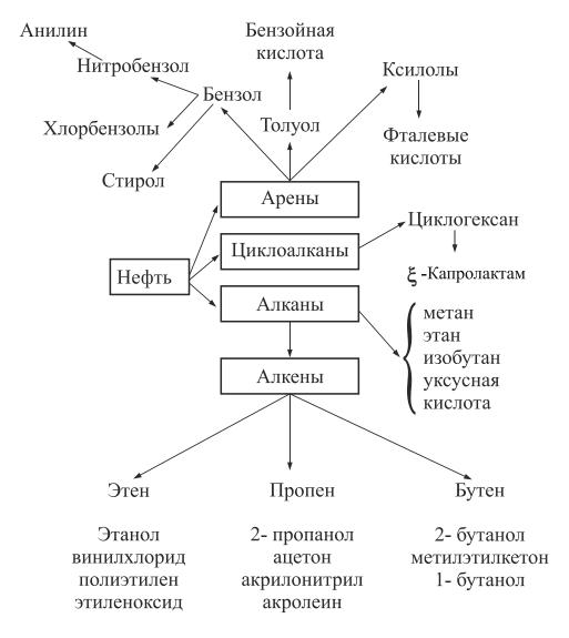
Рис. 3.6. Некоторые химические вещества, получаемые из углеводородов нефти
