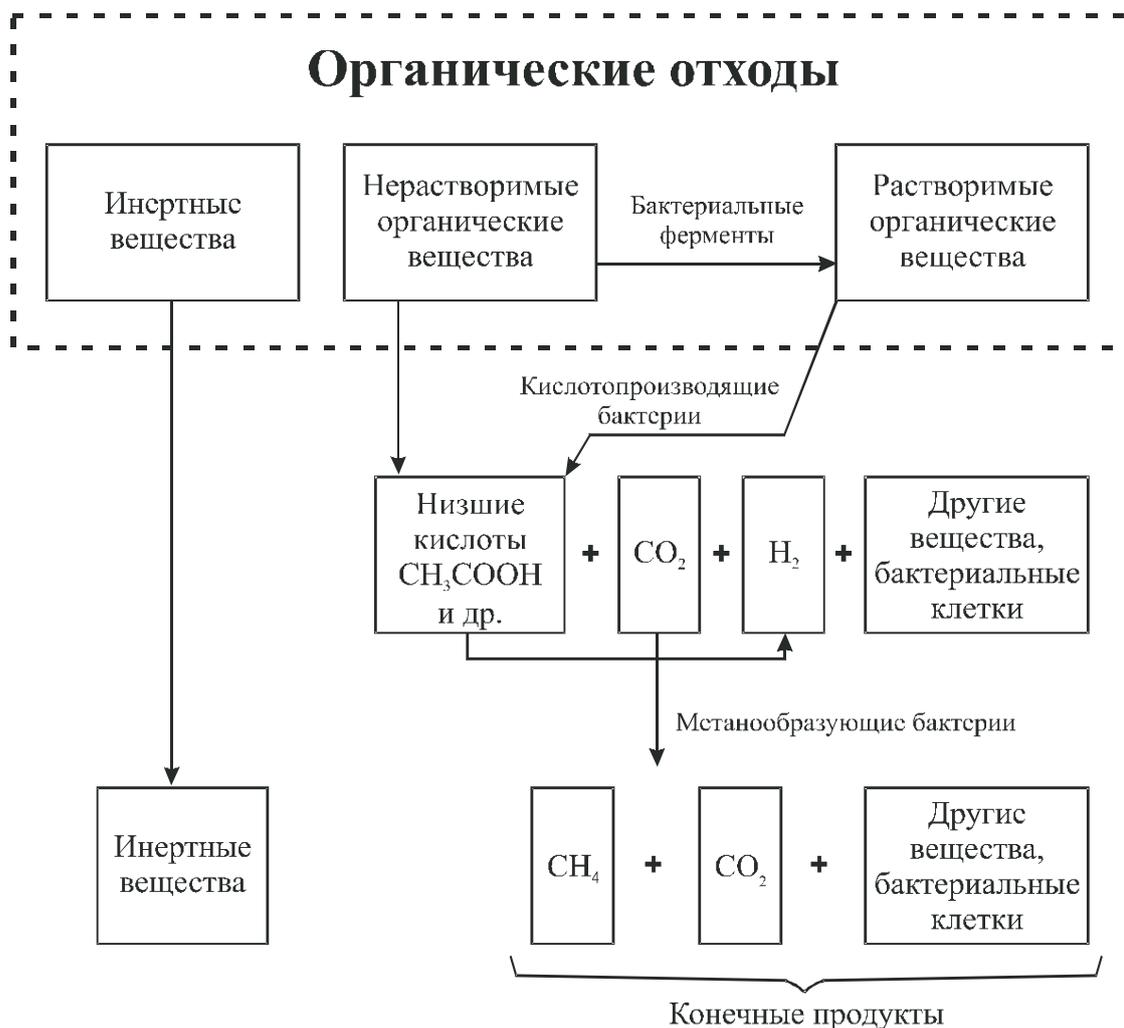
Рис. 3.4. Схема обобщенных реакций биоконверсии органических отходов
