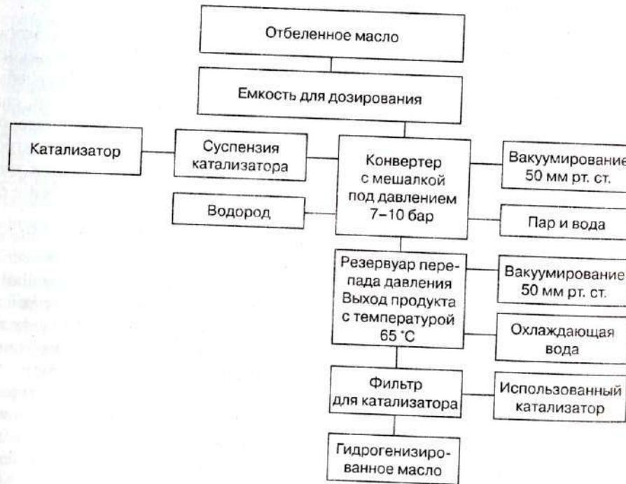
**Рис. 2.6.** Схема периодического процесса гидрогенизации с использованием конвертера насыщения
