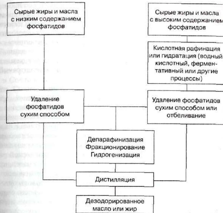
**Рис. 2.2. Блок-схема процесса физической рафинации**
