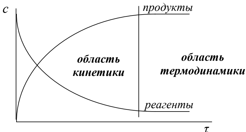
Рис. 3. Зависимость концентрации веществ ( c ) от времени ( \tau ) для обратимой химической реакции
