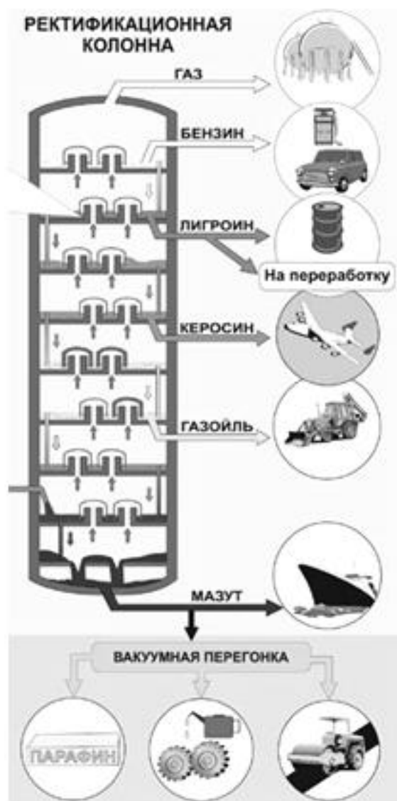
Рисунок 4. Прямая перегонка нефти в ректификационной колонне
