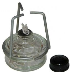
Спиртовка используется для получения низкотемпературного пламени до 900^{\circ}\text{C}
